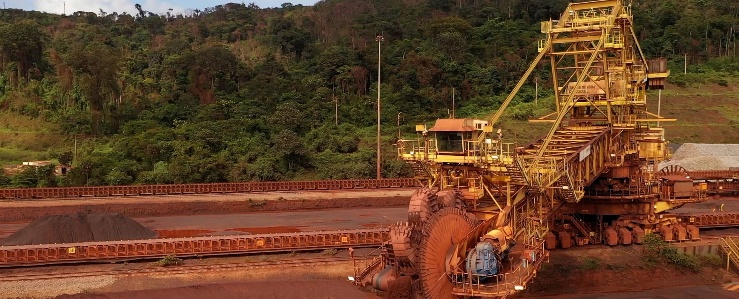
Recuperadora autônoma no pátio de Serra Norte (março 2022)
