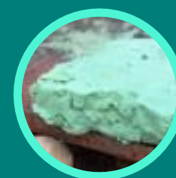
Produto de hidróxido de níquel do tratamento de água (>20% Ni)
